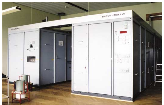
300-kW-Langwellensender; links die Modulatorstufe, rechts Steuer- und HF-Stufen; vorn links ausgetauschte Senderöhren
