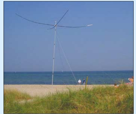
Spider Beam von DF4SA am Strand – eine vollwertige Yagi für 10, 15 und 20 m, die es inzwischen auch als Bausatz zu kaufen gibt.
