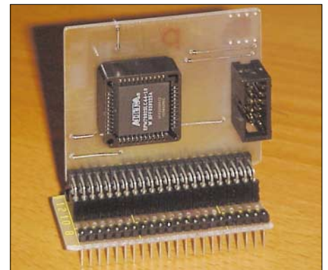
Bild 12: Die Buchse auf dem Entwicklungsboard gestattet das Abtrennen des Programmers nach dem Beschreiben des FPGAs. Fotos: OE1R1B
