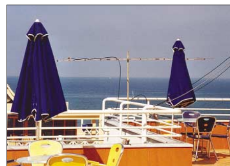
Die 9-Ele.-Yagi für 2 m Richtung DL auf der Hotelterrasse. Fotos: DL6LAU
