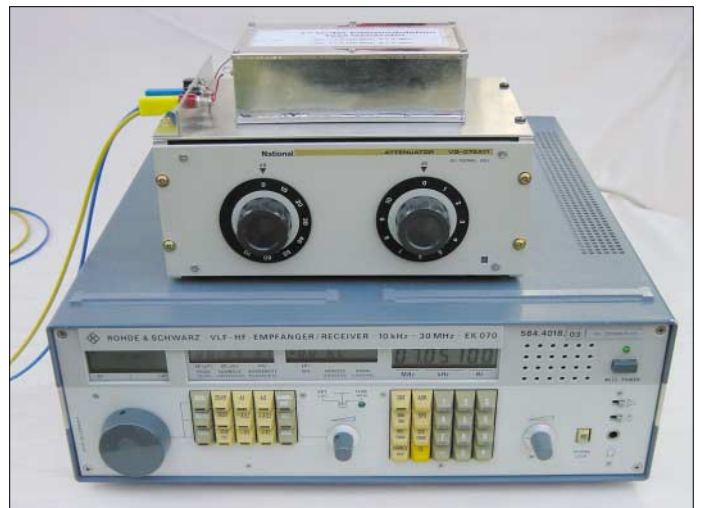
Bild 4: IM-Messgenerator (oben) mit Dämpfungsglied bei einer Messung des Interzeptpunkts des R&S EK070
