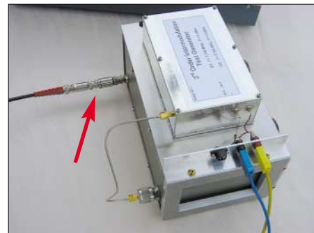
Bild 2: Seitenansicht des Testgenerators mit darunter angeordnetem Dämpfungsglied. Zur Bestimmung des Empfänger-Grundrauschens sind zusätzliche Festdämpfungsglieder aufzustecken (Pfeil).
