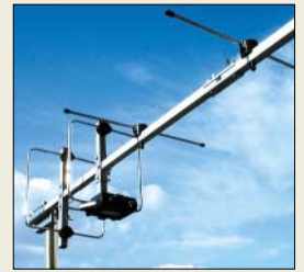
116 cm langer Quagi-Richtstrahler für 435 MHz mit 10,5 dBd Gewinn
